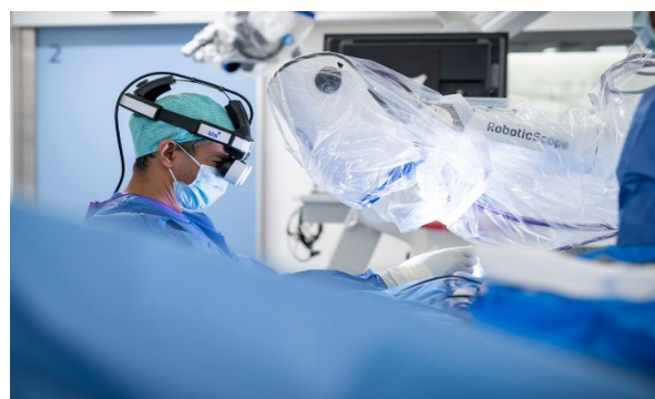
Ein hochpräziser Roboter, eine hochauflösende 3D-Kamera und ein innovatives Head-Mounted-Display – fertig ist das weltweit erste RoboticScope. Bild: BHS Technologies GmbH
